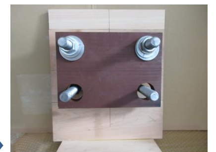
●15 「ブラケット」の状況 (1) ※上側の金具のみで抑えている
