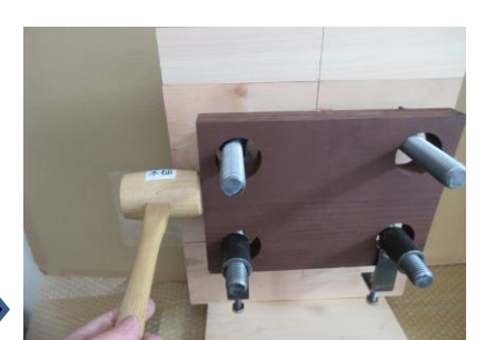
●09 水平方向への移動 ※金具の回転・移動に注意
