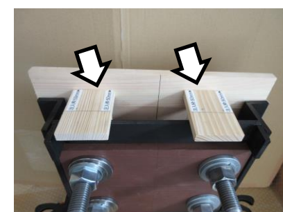
●20 「注入枠(上部補助板)」設置 ※注入枠設置ガイド-50を使用 ※注入部位の幅：50mm
