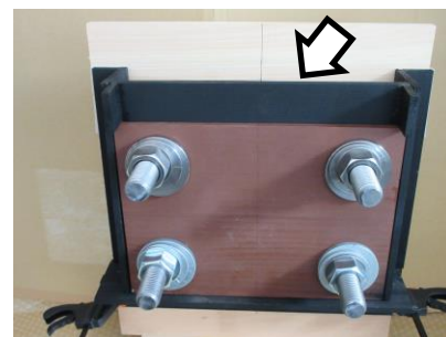
●16 「注入枠(上部補助板)」
