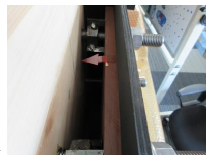
●18 注入部位の状況 ※[隙間]: 35mm+15mm
